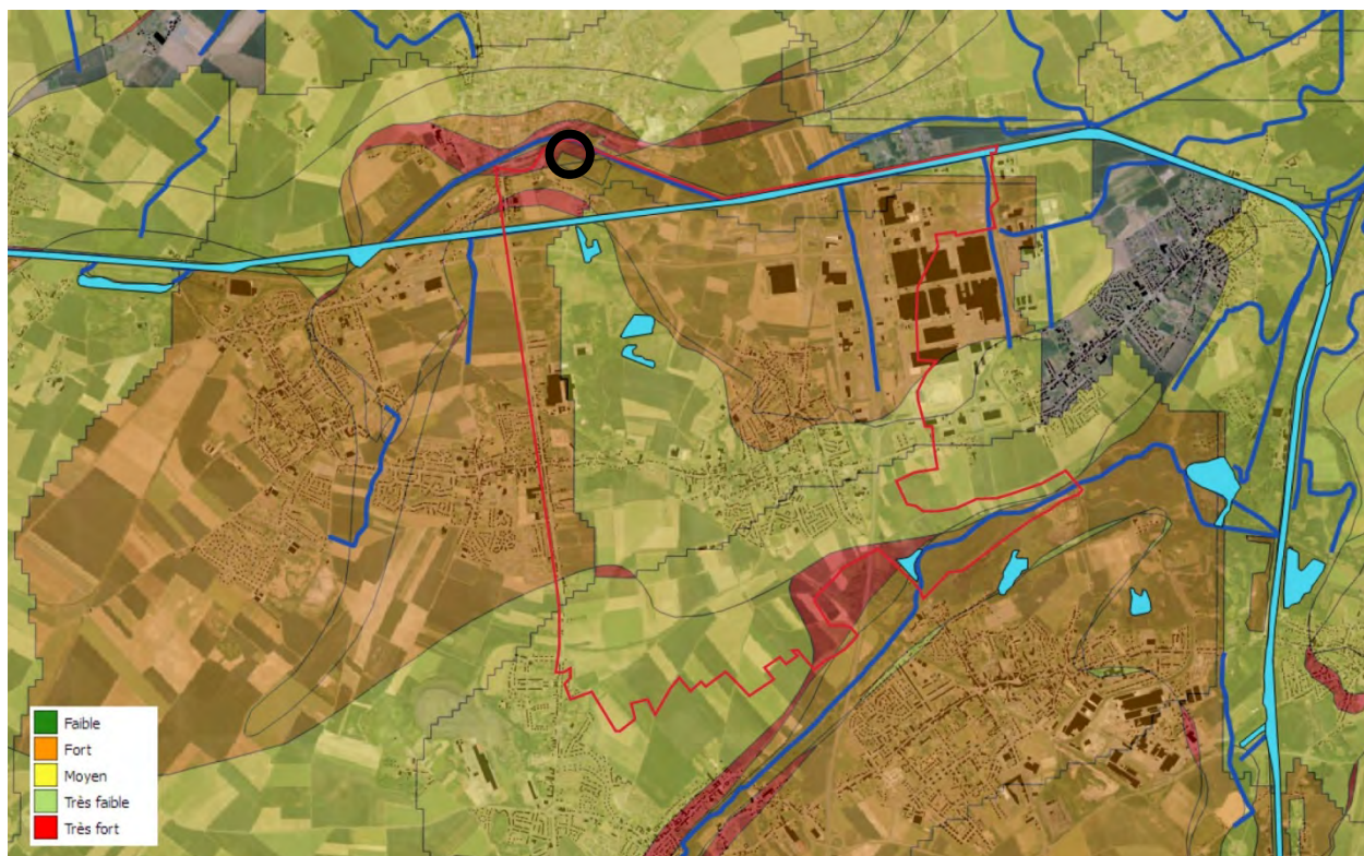
Vulnérabilité de la nappe à Douvrin - Source VCNDF
