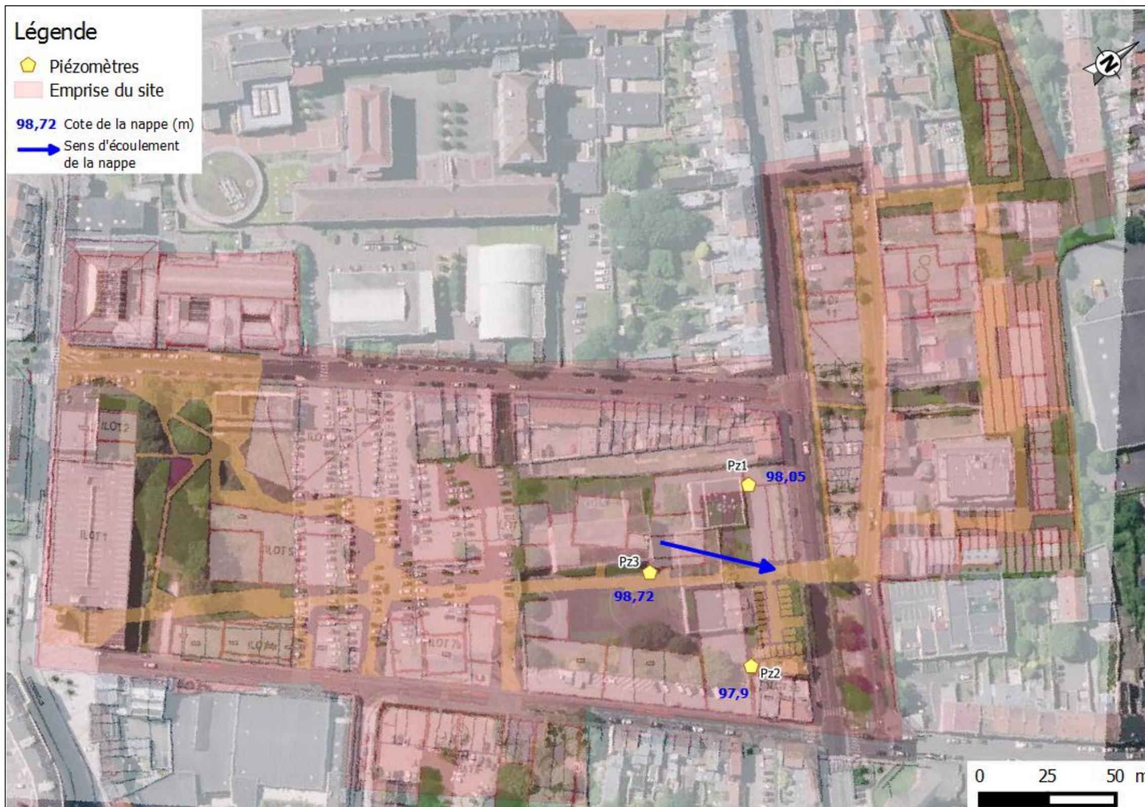
Figure 7 : Localisation des ouvrages et esquisse piézométrique en date du 09/01/2017
