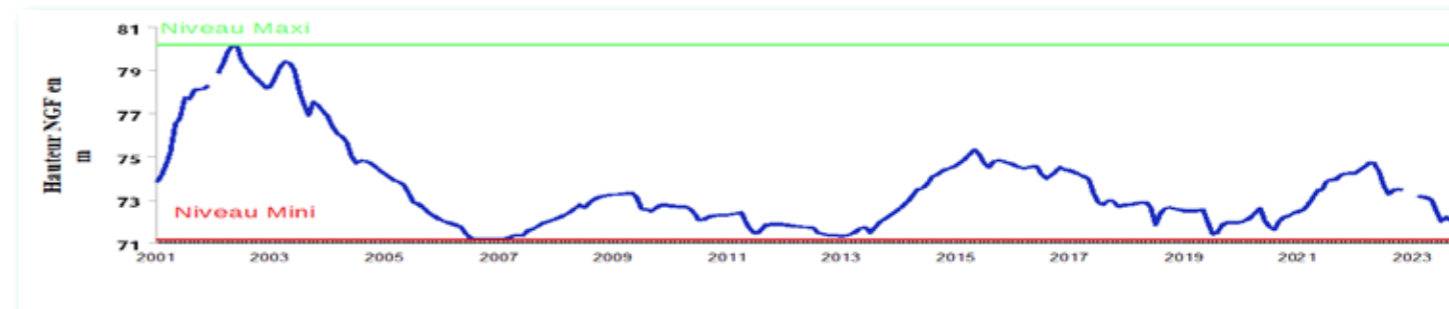
Fluctuation de la nappe de la craie à Vauvillers, caractéristique de la nappe du Santerre (aquifère libre à grande inertie), craie séno-turonienne - Altitude du sol : +90.0 NGF
