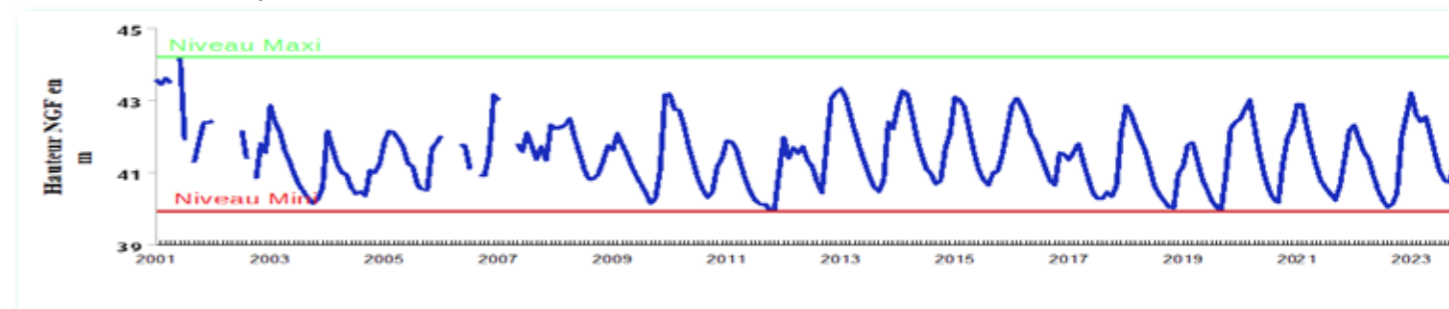
Fluctuation de la nappe du calcaire Oolithe à Wirwignes, secteur du Boulonnais, Jurassique supérieur Altitude du sol : +47,7 NGF
