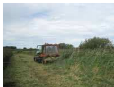
L'utilisation d'une dameuse chenillée équipée d'un gyrobroyeur permet de faucher de larges layons dans les endroits les plus humides du marais de Villiers (62). photo : B. Gallet/CSN-NPC
