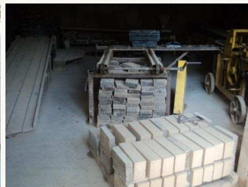
Atelier de fabrication de briques en terre crue
