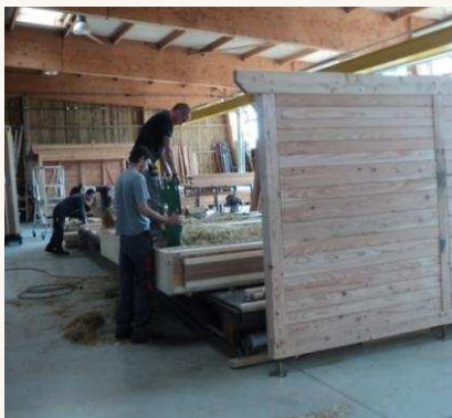
Atelier de préfabrication des « caissons » passifs avec isolation paille
