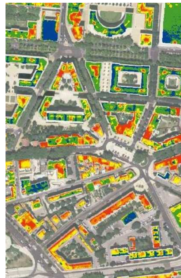
Photogrammétrie aérienne de Montpellier: les zones en rouge montrent les surfaces les plus chaudes, donc non isolées.
