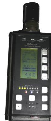
**Figure 9 : Détecteur d'ultrasons Pettersson D 1000X, calé sur une fréquence de 44 kHz.**
