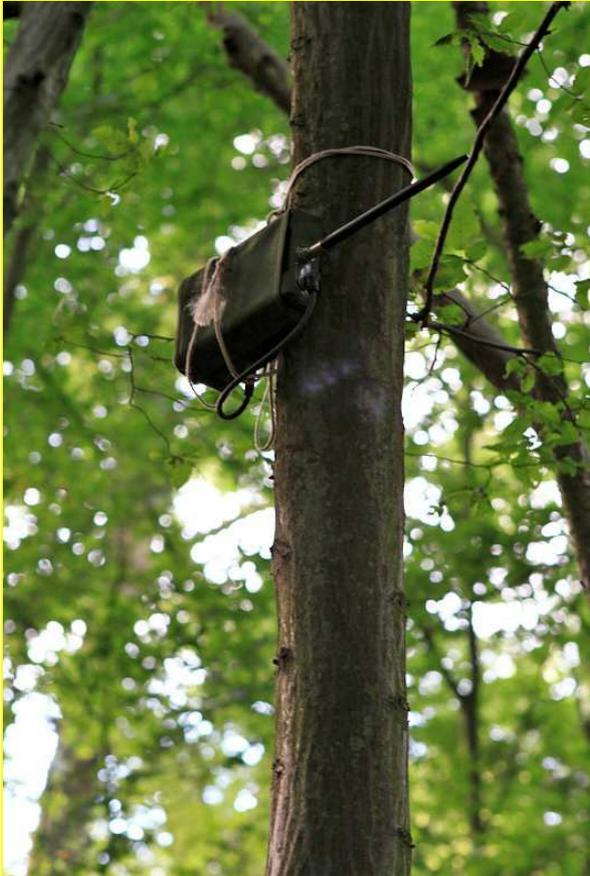
Figure 10 : Batcorder installé en hauteur sur un Charme en bordure de la Solre (Solre-le-Château)
