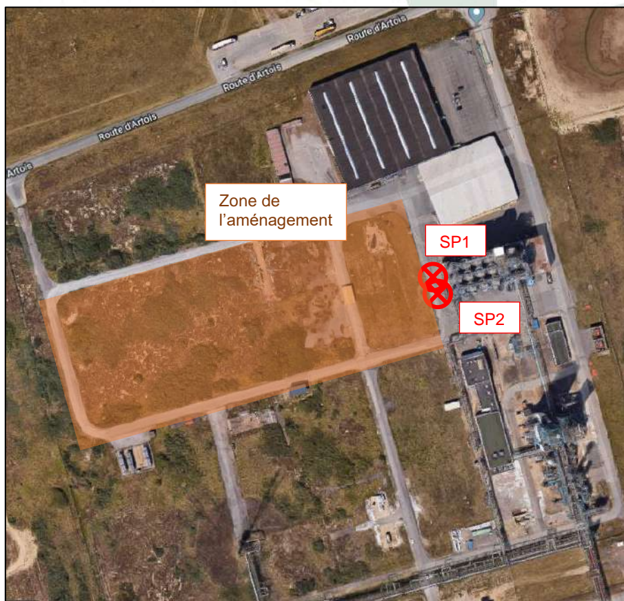
Localisation des deux sondages géotechniques
