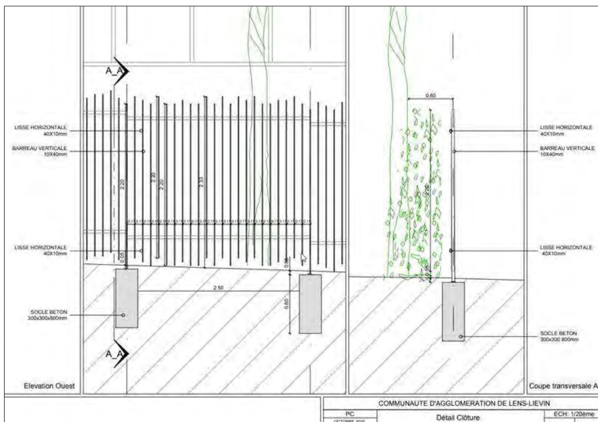
Détail de clôture, Groupement SOGEA CARONI, Octobre2020
