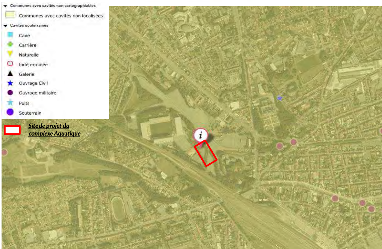
Aléa cavités souterraines – Source : BRGM,
