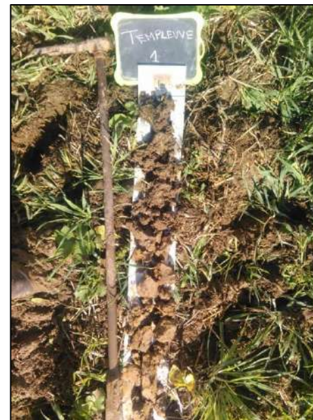
Photo 7: sondage 1 avec horizon rédoxique en profondeur
