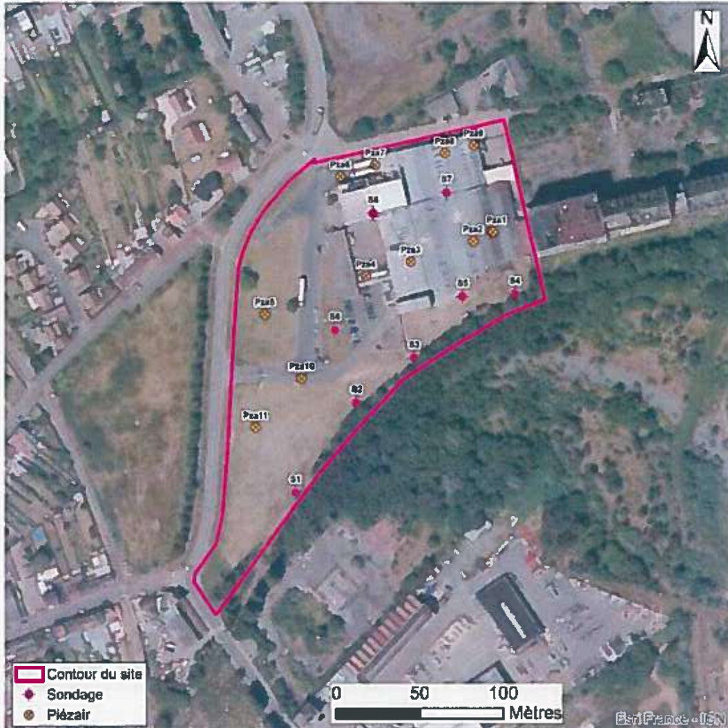
Figure 5.1 Localisation des investigations de sol
