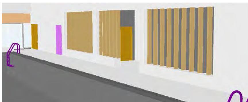
Séparation ajourée avec baffles acoustiques - bassin sportif
