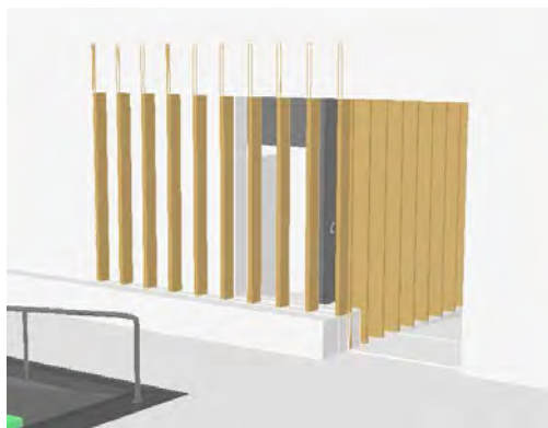
Séparation de la zone du pédiluve avec baffles acoustiques – bassin balnéo-ludique
