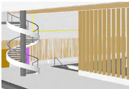
Baffles acoustiques séparant le toboggan du bassin d'activités
