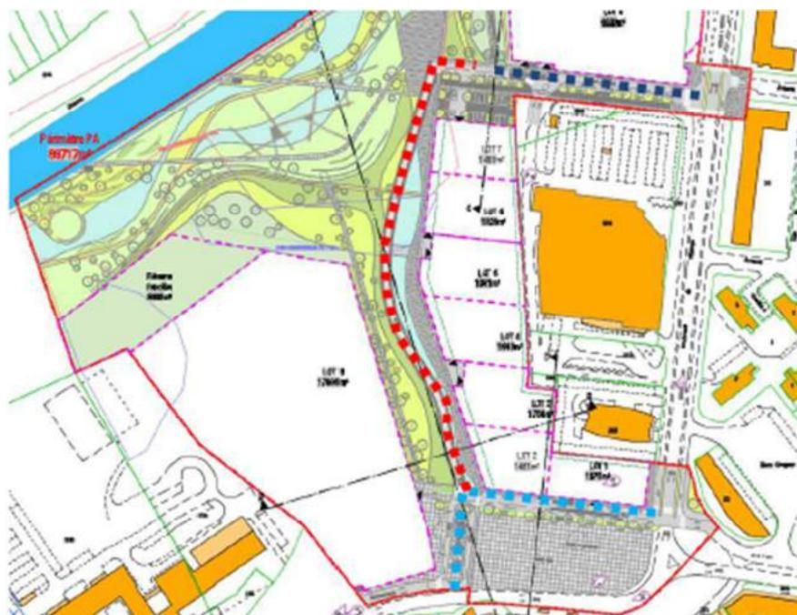
L'axe principal en double sens traversant le pôle gare depuis le boulevard de l'Europe aura une emprise de 13.40m. Le profil sera décomposé de la façon suivante : voirie de 6.00m bordée d'un côté d'un trottoir de 2.00m et de stationnements de 2.30m et de l'autre d'une bande d'espace vert de 3.00m. Une giration sera possible autour de l'ilot recevant du stationnement dépose minute pour la gare afin de ressortir par le boulevard de l'Europe.
