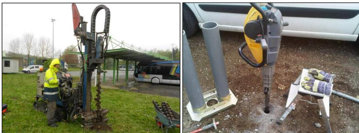
**Photographies 1 et 2 : Atelier de sondage Hydra Joy 2 et carottier à gouges portatif**
